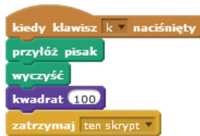
Rys. 4. Układ bloków procedury kwadrat (a) i sposób jej wywołania (b)
