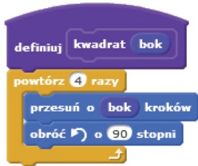
Rys. 4. Układ bloków procedury kwadrat (a) i sposób jej wywołania (b)
